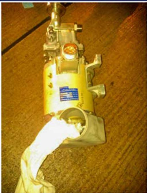
Se quitó la bomba hidráulica con el trapo aún colocado.
