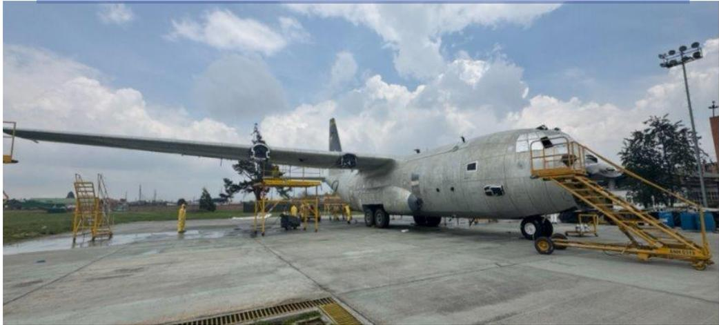
**FAC-1017:** Inicio el servicio de mantenimiento mayor (PDM) e ISO 4 con énfasis en la remoción de componentes y trabajos de pintura, así como el inicio de múltiples inspecciones estructurales y funcionales. Se finaliza el semestre con un 37% de avance del servicio programado y se reciben los motores para la aeronave.
