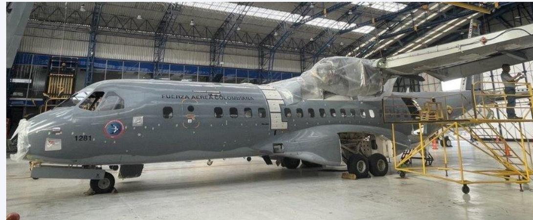
**FAC-1281:** Aeronave ingresa para ejecución de Servicio Mayor (8Y). Se completó la inspección de la aeronave con 325 tareas y 317 reportes evaluados. Se removieron componentes críticos, se preservaron motores y se inició la fase de chequeos funcionales y corrección de reportes.
