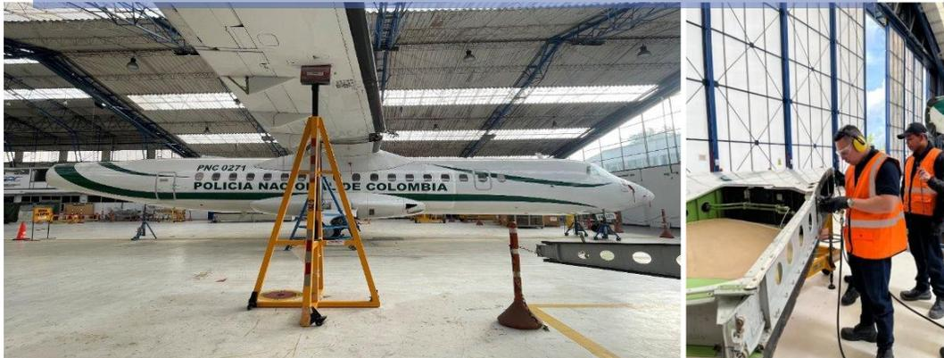
**PNC-0271:** La aeronave ATR 42-500 está en la fase final de mantenimiento, con un avance del 97.5%. Se han completado el 100% de las tareas programadas y el 69% de las no rutinarias. Se realizaron inspecciones, reparaciones, consultas técnicas y adquisición de recursos. Además, se ejecutó el procedimiento de "Flat Peening" en los lower fittings del estabilizador vertical como parte de una reparación estructural mayor.
