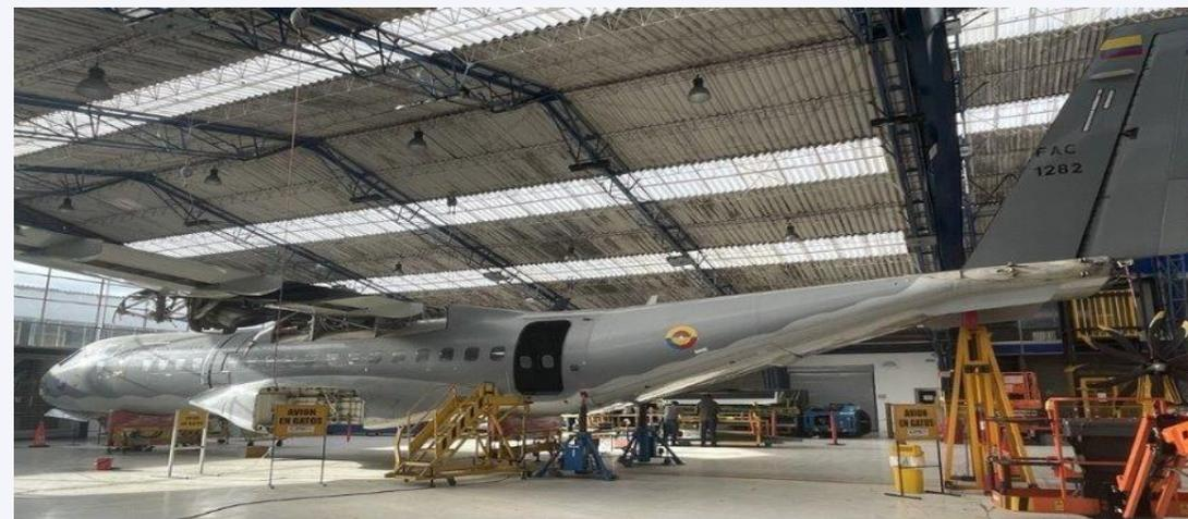
**FAC-1282:** Aeronave ingresa para ejecución de servicio Mayor (8y). Se inició la remoción de componentes controlados para su envío a taller externo (como trenes de aterrizaje principales, ruedas, baterías, sensores, intercambiadores y luces de emergencia). Además, se realizó la apertura de múltiples accesos en la aeronave para facilitar estas labores.
