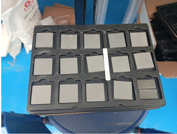
Material cerámico que recubre el polietileno
